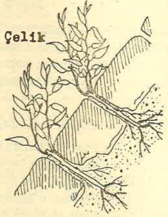
Şekil : 12. Taş blokaj ile kaplanmış şevlerde odunsu çeliklerle tahkim.
