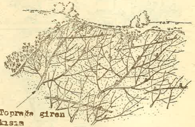
Şekil : 7b. Yarma şevlerde dal örtüsü ile tahkim. Dallar ve dalcıklar, çatal kazıklarla toprağı tesbit edilirler.
